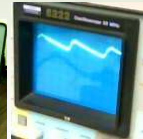
3) effet condensateur (avec ondulation résiduelle)
