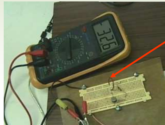
Mesure du courant total ( I_b + I_c ) (collecteur connecté)
