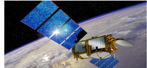
Tous les satellites météo diffusent en continu et en temps réel les images qu'ils capturent. Les satellites NOAA fonctionnent 137 MHz (VHF) et leur réception est plus simple à mettre en œuvre que les Météosat et les METEOR. Compte tenu de l'altitude des satellites, **on ne peut recevoir que des images de l'Europe** et il faut attendre qu'un satellite soit en vue pour recevoir ses images.
