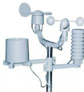
Il existe des stations météorologiques plus ou moins complexes. **Les stations météo plus simples donnent la température, la pression atmosphérique et le taux d'humidité.** D'autres plus complexes (comme celle présentée) intègrent un anémomètre et une girouette (pour mesurer la force et la direction du vent) et un pluviomètre. **Mais ceci ne vous donne qu'une observation de la météo locale.** Et il est difficile de prévoir le temps des prochains jours.
