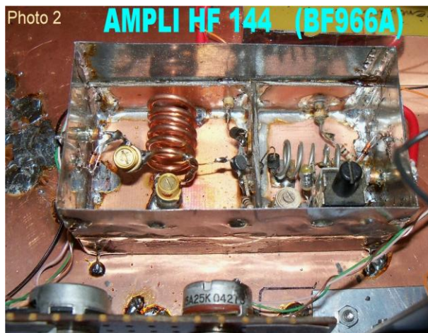
Exemple de préamplificateur VHF un mosfet BF966A
