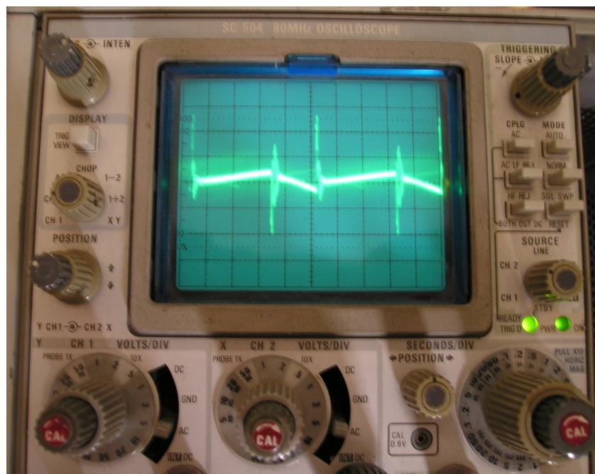
L'oscillogramme de la tension sortie de la batterie de secours (1800mAh 5V) débitant un courant d'une intensité de 500mA montre :
