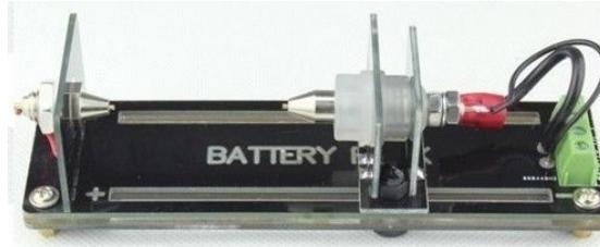
Le test s'effectue avec une intensité du courant débité de 300 mA et une tension de seuil minimal de 3 V.
