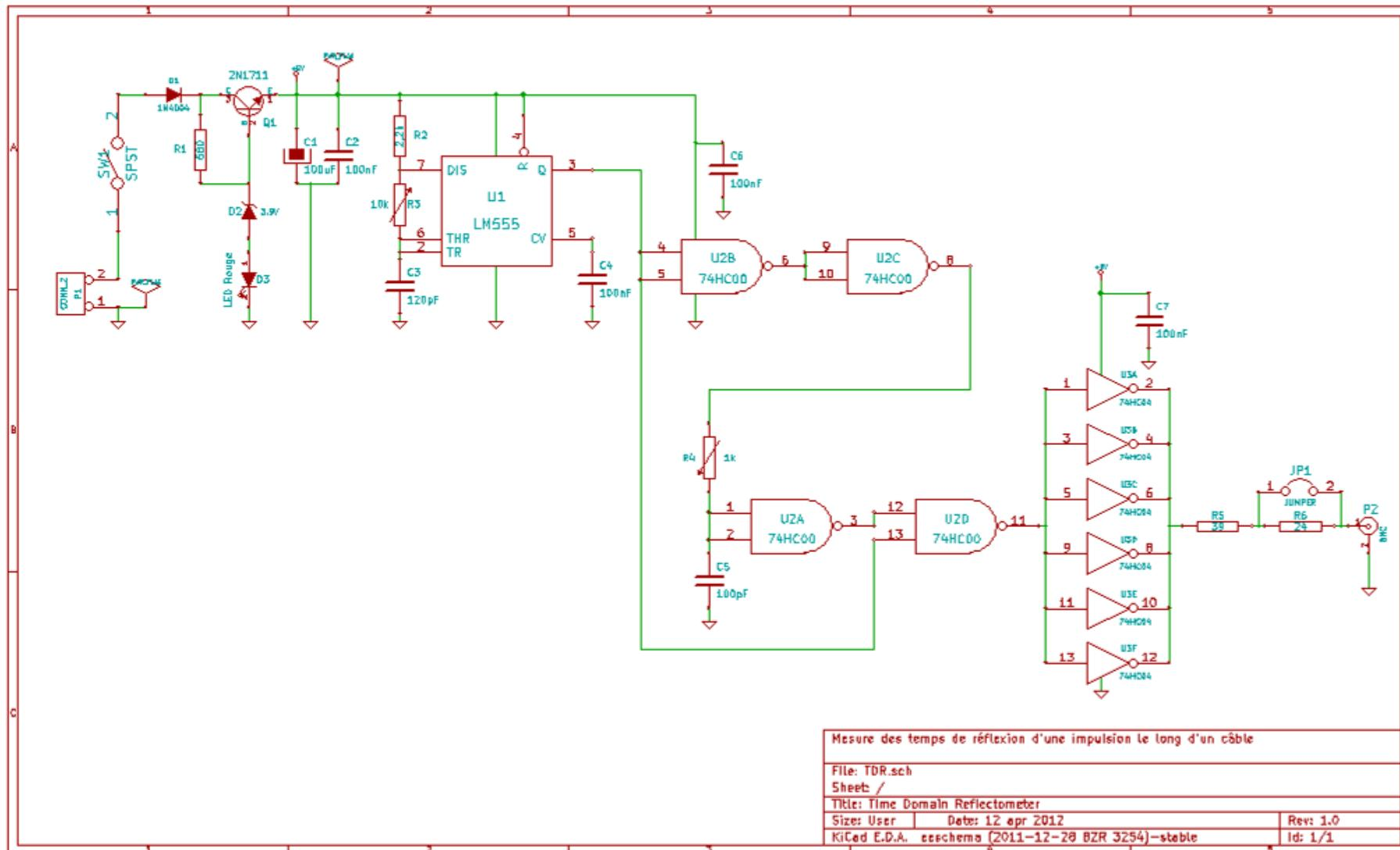
Le réflectomètre (partie générateur d'impulsions) fonctionne suivant le principe mentionné dans le chapitre précédent, il génère à intervalles réguliers des impulsions très courtes de l'ordre de quelques nanosecondes.
