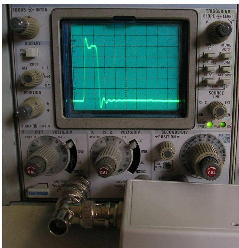
L'impulsion d'une durée de 25 ns environ a une amplitude de 5V avec une légère oscillation.
